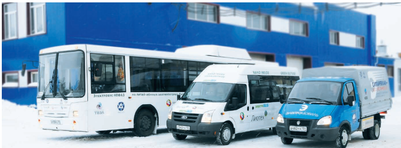
«На предприятии уже больше года идет испытание электротранспорта. Это автобус, который возит людей по территории, грузовая «газель» и микроавтобус «форд». Мы пробуем, как в сибирских условиях будет работать транспорт на литиевых источниках тока.»
