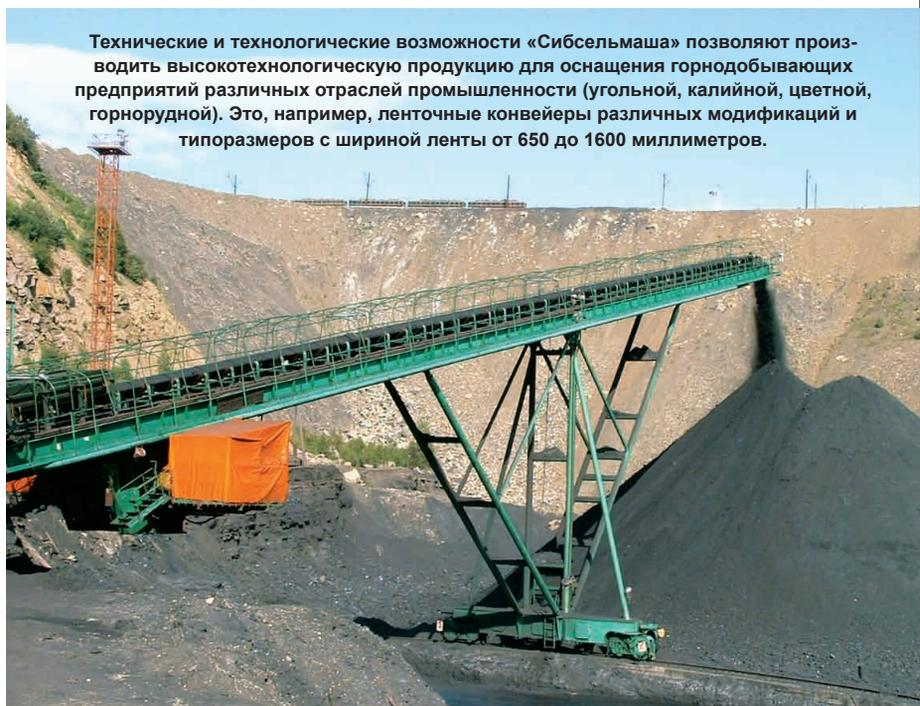
Технические и технологические возможности «Сибсельмаша» позволяют производить высокотехнологическую продукцию для оснащения горнодобывающих предприятий различных отраслей промышленности (угольной, калийной, цветной, горнорудной). Это, например, ленточные конвейеры различных модификаций и типоразмеров с шириной ленты от 650 до 1600 миллиметров.
